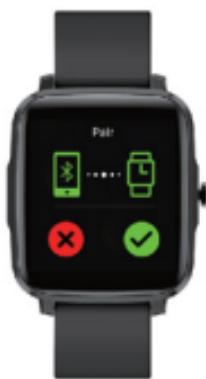
(Θα πρέπει να χρησιμοποιείται Android 4.4+ ή iOS 11.0+ και άνω και το ρολόι μπορεί να συνδεθεί μόνο με ένα κινητό τηλέφωνο. Προκειμένου να πραγματοποιήσετε σύνδεση με άλλα κινητά τηλέφωνα, πραγματοποιήστε αποσύζευξη του τρέχοντος προτού πραγματοποιήσετε κάποια νέα σύζευξη.)
